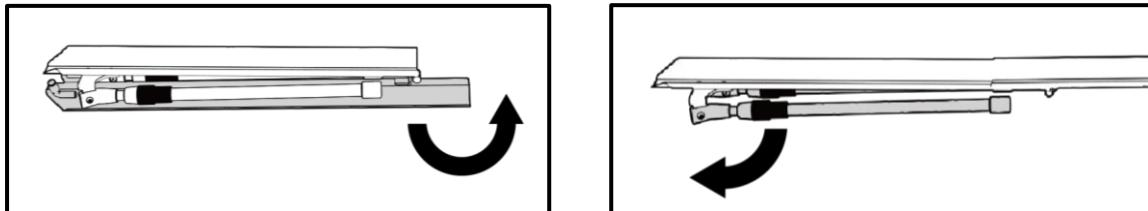
Lege die Auffahrtschiene neben den Fahrradträger und stelle nun die Höhe ein. Löse dazu die Kontermutter, schiebe den Fuß auf richtige Länge heraus und ziehe die Kontermutter wieder fest. Wiederhole diesen Vorgang für beide Stützbeine.
