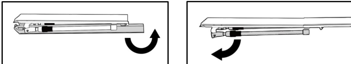
Placez la rampe à côté du porte-cycles et réglez la hauteur. Pour ce faire, desserrez le contre-écrou, faites glisser le pied à la bonne longueur et resserrez le contre-écrou. Répétez cette opération pour les deux pieds de support.
